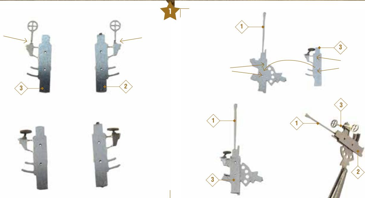
1. Давайте ненадолго прервем обшивку модели и установим третий зенитный полуавтомат одной из четырех башен главного калибра. Извлеките **детали 2** и **3**. Согните их под **углом 90°** в указанных на рисунке местах.
